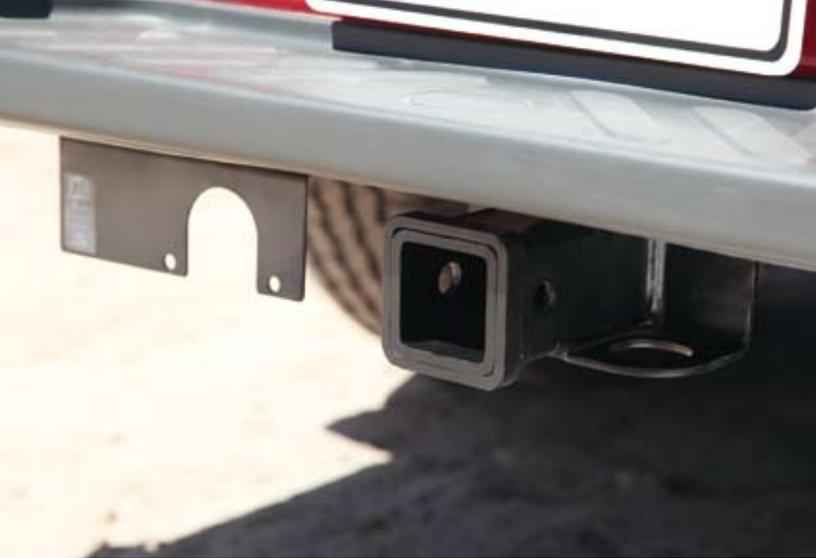
► Receptor de remolque 999T5BY500
